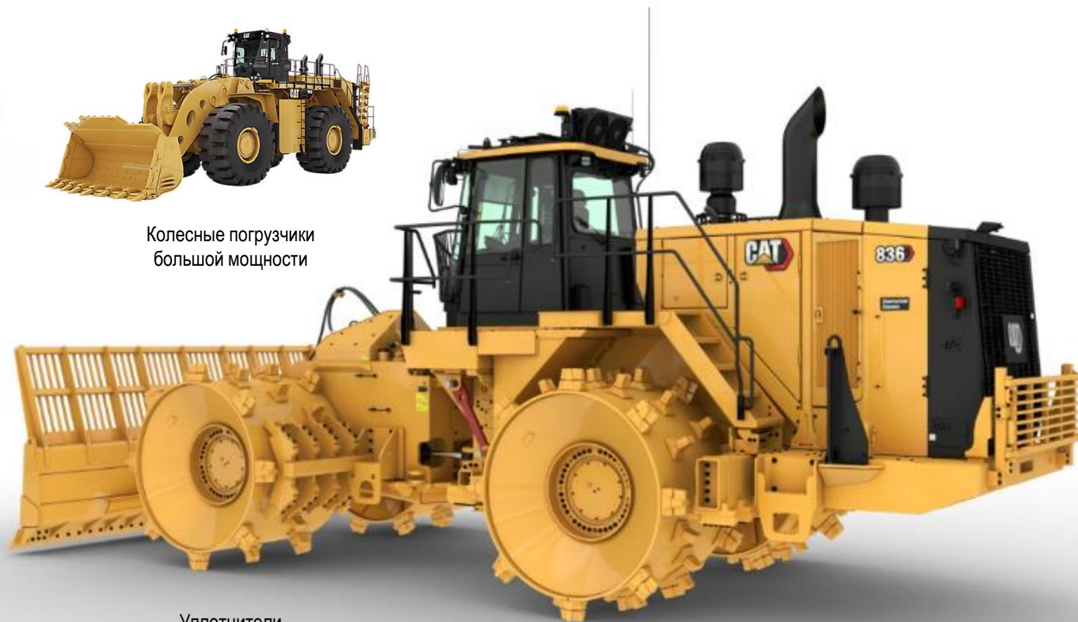
Уплотнители закладки отходов
